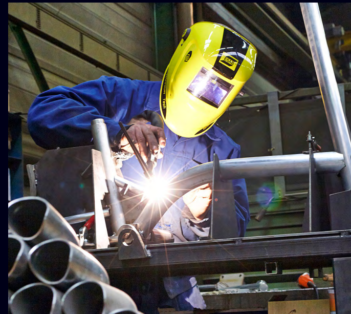
Soudage des éléments du cadre réalisé par un des ouvriers qualifiés de la CFL.
